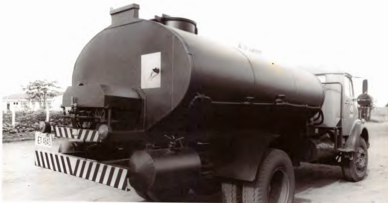
Espargidor de Asfalto ( Burro Preto)
